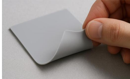
TIM (Thermal Interface Material) 材は、電子デバイスやパワーモジュールから発生する熱を効率的に放熱し、装置全体の信頼性と性能を向上させるために開発された高熱伝導インターフェース材料です。デバイスとヒートシンク（放熱板）とのわずかな隙間を埋め、熱抵抗を最小化することで、高出力化・高密度実装化が進む電子機器の熱設計に不可欠な役割を果たします。
