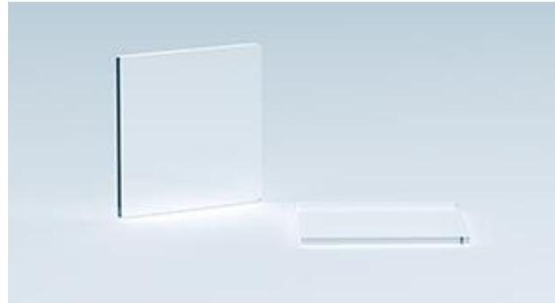
YOFCのYSMシリーズ合成石英は、DUV領域で高い透過率を持ち、金属不純物総量0.5ppm以下の超高純度を実現したフォトマスク基板です。無バブル・無欠陥の高品質インゴットから製造され、優れた平坦度と寸法精度、低TTVにより、FPD・半導体露光工程で高い信頼性と精度を提供します。
